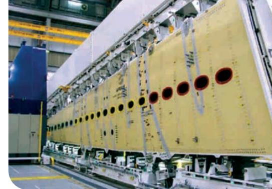
*Componente aeroespacial utilizado para proteger las bocas de inspección de las alas del Airbus.*
